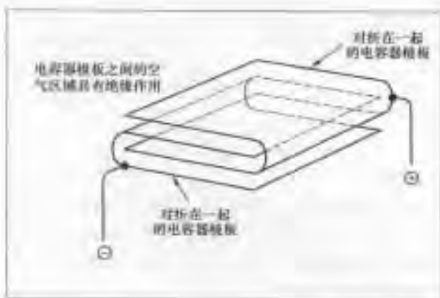
图 17-6 这个电容器有两个对折在一起的极板，可以节省空间。
