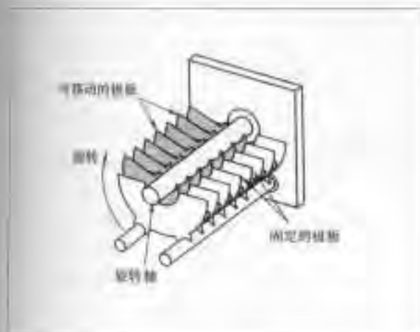
图 17-8 这个可变电容器有两组极板。一组极板可以旋转，而另一组极板不能转动。可旋转的极板（动片）向内旋转或向外旋转离开固定的极板（定片），改变重叠的面积。
