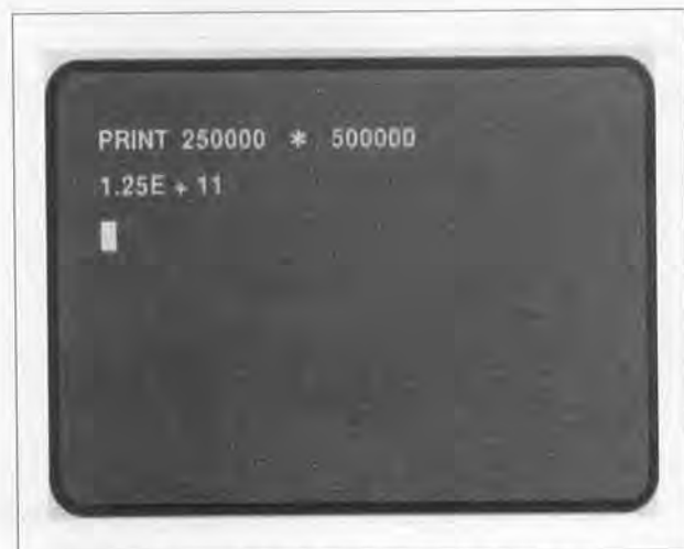
图 2-16 当你输入命令要求输出一个简单乘法运算的结果时，电脑很可能给出这样的输出形式。
