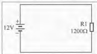
图 23-1 我们用欧姆定律来计算直流电路中电流的大小。
