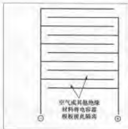
图 17-7 这个电容器有两组极板边各自连接在一起的极板，空气或其他绝缘材料使两组极板彼此绝缘。
