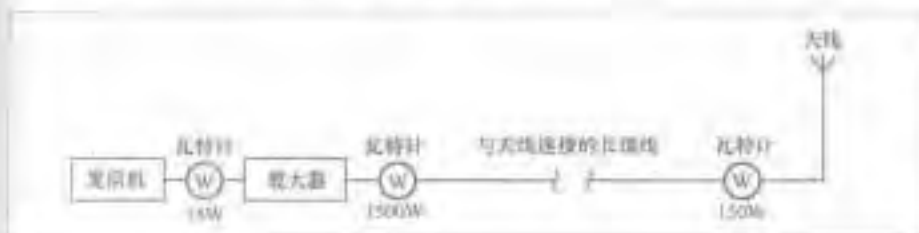
图 15-3 这组图说明了一台业余电台发信机输出功率强度的测量。这张图也显示了信号经过功率放大器和较长的同轴电缆后的功率强度。
