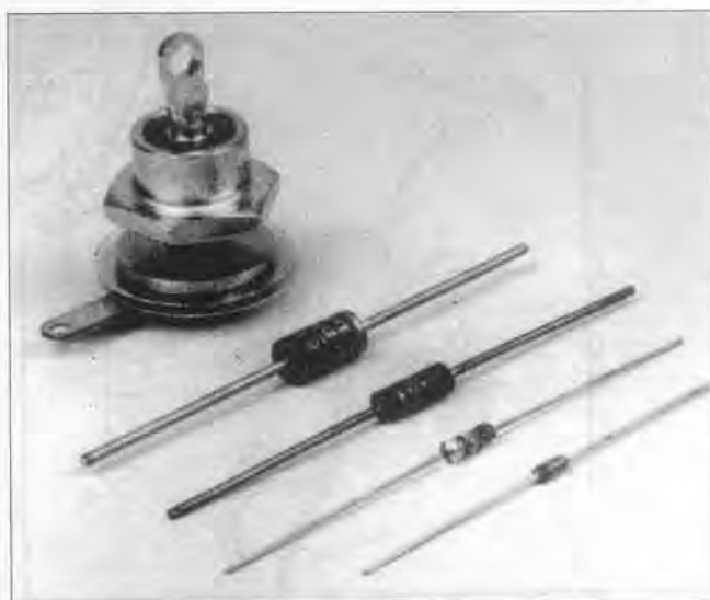
图 26-16 固体二极管有不同尺寸和形状。一般来说,二极管的个头越大,可处理的电流就越大。用螺栓作引线的二极管通常可以安全地通过好几安培的电流。
