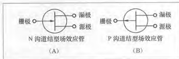
图 28-6 在电路原理图中，图 (A) 表示 N 型沟道结型场效应管，图 (B) 表示 P 型沟道结型场效应管。
