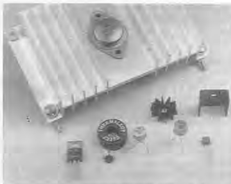
图 27-24 这张图中为一些普通的三极管和典型的散热片。散热片可以把三极管产生的过多热量传导出去,降低半导体 PN 结的温度。
