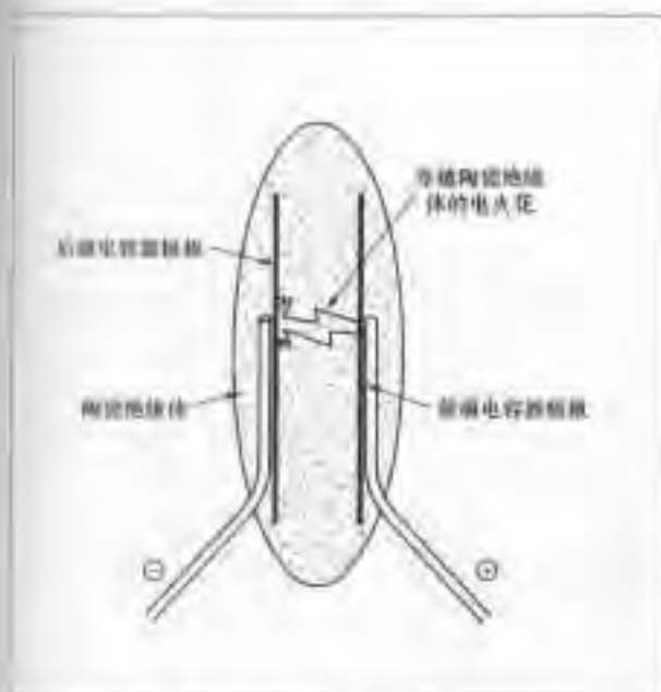
图 17-13 当电压足够大时，电火花将穿过任何绝缘材料。厚度较大的绝缘体需要较高的电压才能产生电火花。
