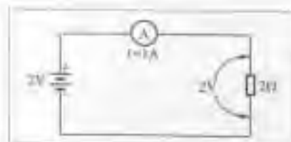
图 14-4 这是一个每秒钟消耗 2J 能量的简单电路。
