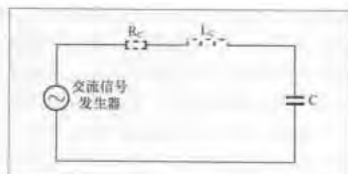
图 21-2 图中包含了一个小电阻和一个电感,它们都是实际电容器的组成部分。虚线标出的电阻器和电感器表示他们是电容器的一部分,而不是电路中实际存在的物理元件。
