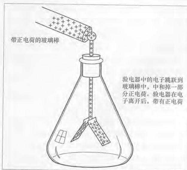
图 9-8 当带正电荷的玻璃棒接触验电器的顶部时，带负电荷的验电器再次带电。现在带正电荷的验电器上的金箔片再次相互排斥而张开。
