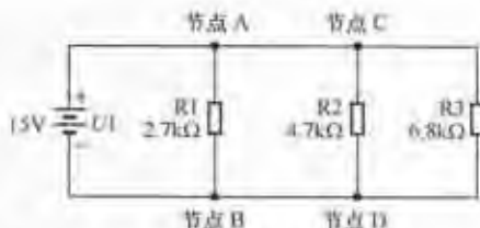
图 13-11 这是一个 3 个电阻与电池并联连接的电路。要想在电路用效果相同的一个等效电阻来代替这 3 个电阻，正文中描述了这个具体过程。
