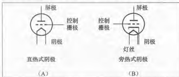
图 30-11 这些符号是电子三极管符号示意图。有些电子三极管的阴极是直热型阴极，有些是旁热式阴极。注意，我们可以从图中符号的左边引出控制栅极导线，也可以从右边引出。
