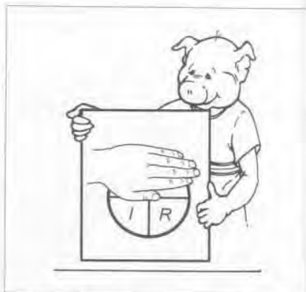
图 12-6 哈姆雷特告诉我们怎样使用欧姆定律“圆”来解决电路中的电压。覆盖住我们要求的量，剩下的字母就告诉我们怎样来解决这个问题。这里，我们必须把电流（I）和电阻（R）相乘，得到电压（U）。
