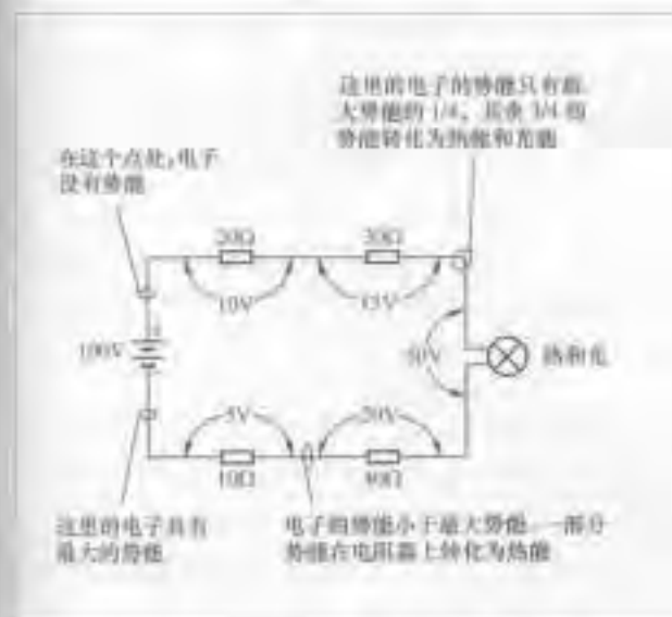
图 14-2 从电池的负极离开,经过电路中任何电阻后,电子的势能减小。电子在正极具有的势能最大,在正极时势能为0。(在这里不要混淆惯例电流的方向和电子流动的方向。对于惯例电流,我们将认为在电池的正极势能最大,和着眼于电子的叙述正好相反。)
