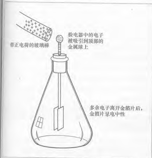
图 9-7 当你把带正电荷的玻璃棒靠近带负电荷的验电器，金箔片将闭合。这是因为带正电荷的玻璃棒把额外的电子吸引到验电器的顶部，使金箔片再次呈电中性。
