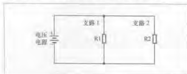
图 11-6 只是一个简单并联电路的例子。至少有两条通道可以让电子从电池的负极流出，回到电池的正极。
