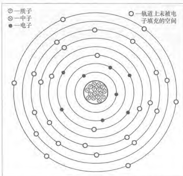
图 25-3 我们所画的是一个氧原子中的电子层或电子轨道图。这些轨道中，每条轨道可以容纳一定数量的电子。在具体的轨道上，电子具有特定的能量。越是远离原子核的轨道上的电子，具有的能量越大。
