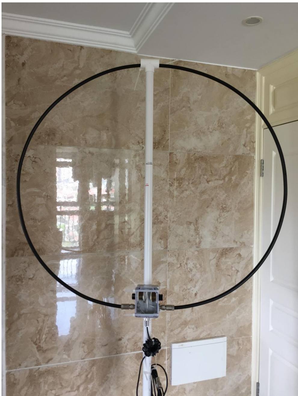
图 11 “Army Loop” 小环天线整体图
