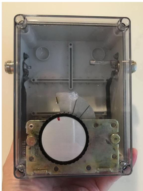
图 13 用另一种电容做的调节盒。双联电容 130/380Pf，串联接入使用，与前述的馈管环配用，覆盖频率 14~21 兆，承受功率 100 瓦。也进行过通联。
