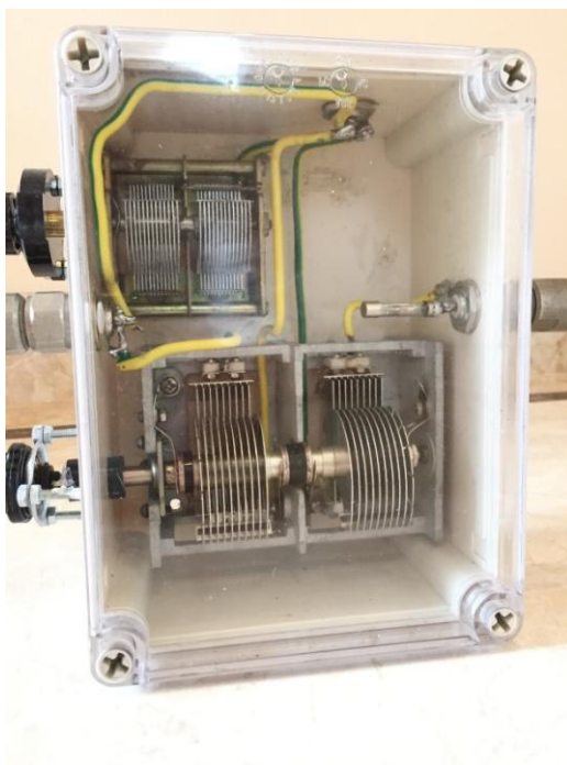
图 11 “Army Loop” 小环天调节电容盒图 （下为谐振电容，上为匹配电容仅用一联）
