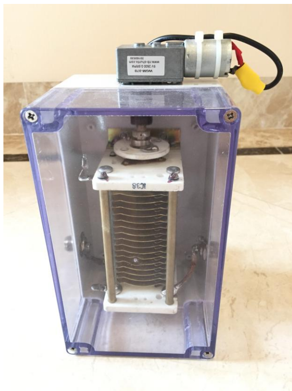
图 12 电动机驱动控制的电容盒。
