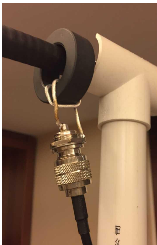
图 4 磁环变压器装配图
