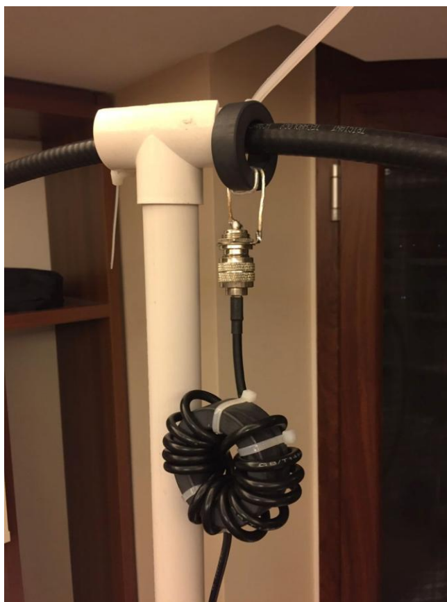
图 6 巴伦与磁环变压器的连接
