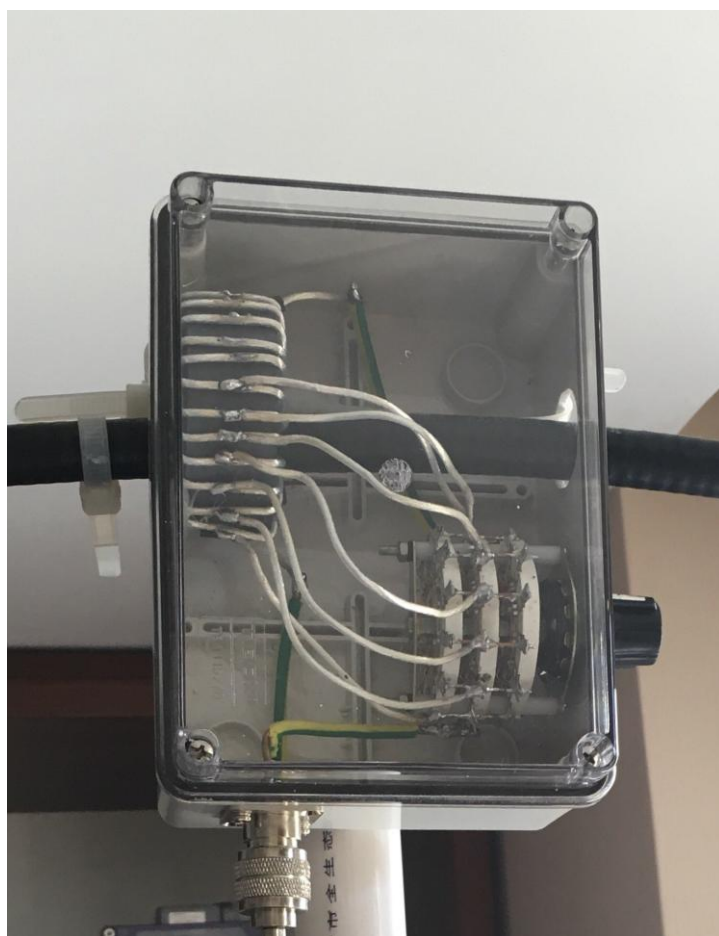
图 11 带抽头的磁环耦合线圈
