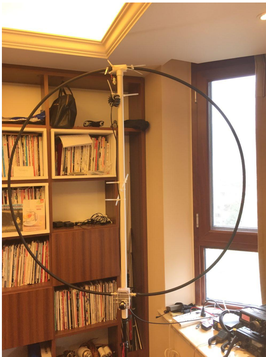
图 1 用磁环变压器馈电的小环天线完整实体图
