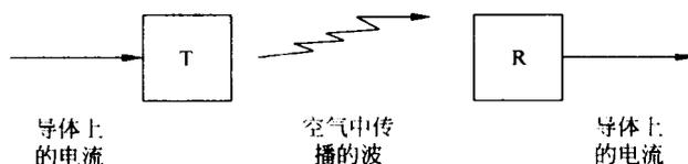
图 1-1 通用无线系统方框图
