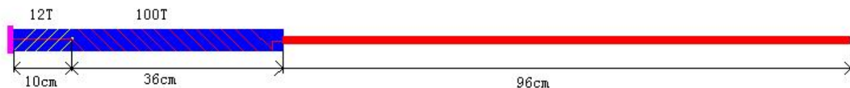
14.270MHz天线，加感线圈线径1.41，PVC管径16mm，PVC管长46cm，铝管长1米，直径8mm，天线总长142cm，中心频点14.300，驻波1.3。
