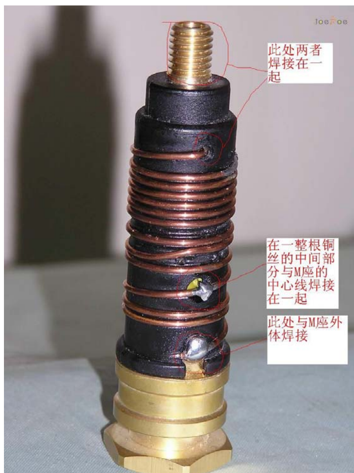
内部的解剖图及焊接方式
