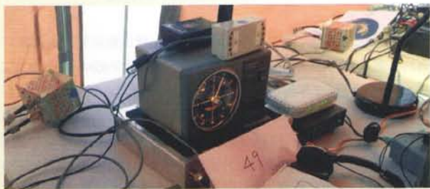
放着我们比赛呼号的49号信封、功率监控、旋转控制器、集成三工器BPF和切换开关、天调、HUB、树莓派、音频切换盒以及裁判的耳机
