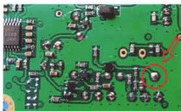
陶瓷滤波器焊点
