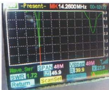
全频段扫频测试，驻波曲线
