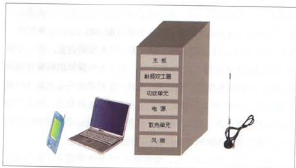
图1 伪基站硬件结构组成图
