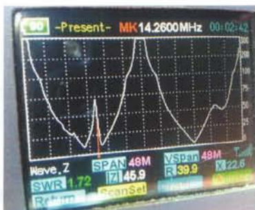
全频段扫频测试，阻抗曲线
