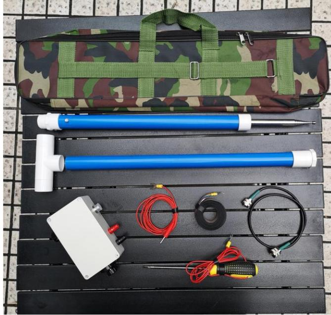
本端馈盒如在野外用，想效率高可以直接接一根 21 米的长电线，架设方式离地 2 米以上，越高越好，可一端捆一瓶矿泉水丢上树，尽量架高，通过调节两个旋钮大部分波段都可以用，留作大家 DIY 用。野外架本拉杆时，80 米无法用、40 米段用螺丝刀地线直接插进泥土，如泥土干燥可用水打湿，不然驻波下不来，其余波段直接用 20P 排线地网以方便水泥地面架设。如 40 米驻波下不来，试下排线地网卷起，前面有提到卷的样式，野外功能全当附送，本天线主打阳台。
