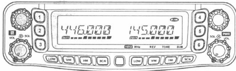
FT-8900R 是一款堅固耐用的、高質量的四小波段調頻收發信機。在 29/50/144MHz 段，本機提供 50W 的輸出功率。在 430MHz 段，本機提供 30W 的輸出功率。
