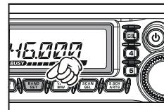
144MHz → 250MHz → 350MHz → 430MHz → 850MHz → 144MHz...
