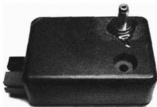
4mm × 1.7mm 电源头用环氧树脂固定在壳子上
