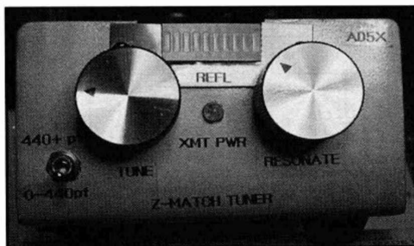
图 5-6 条形 LED 显示更加直观。
