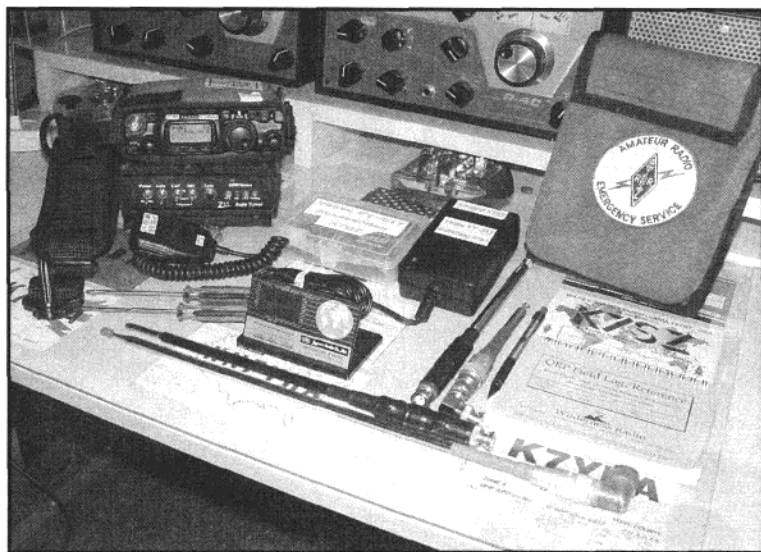
图 4-12 Yaesu FT-817 收发信机覆盖从 160m 到 70cm 的所有波段。这里，作者的“旅行套装”散放于他的操作台上。(摄影：K7SZ)
