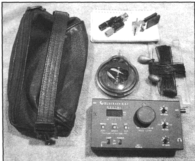
图 4-5 坎莫·哈特福德 (N6GA) 将整个短波电台装进一个小腰包用于山径边的操作。顺时针从左边开始是腰包、上边是小笔记本和钢笔以及用于天线连接的 BNC- 接线柱转换器和 KXPD1 插入式自动键体、线轴绕的是天线用导线和两个 1 盎司钓鱼用铅坠以及 KX1。中间塑料盒中是一条耳塞式耳机。(摄影: N6GA)
