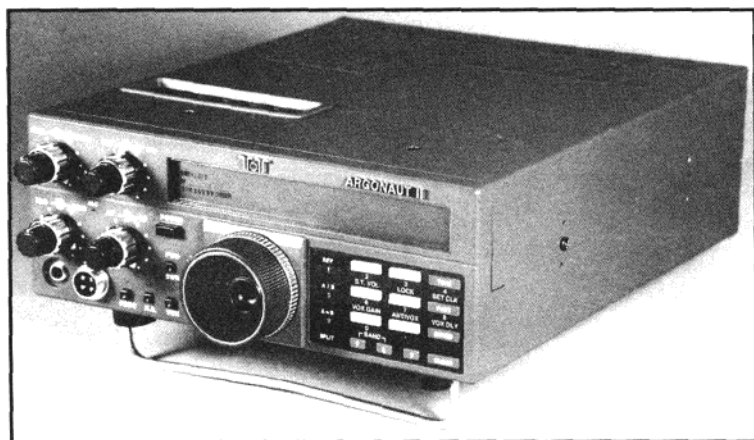
图 4-18 Ten-Tec Argonaut 535 (Argonaut-II) 是在市场上销售多年的全功能 QRP 电台。基本上是 Delta-II 收发信机去掉 100W RF 部分，这个电台有许多特色功能，包括完全可变的 IF 带宽和计算机控制。尽管这个 QRP 电台由于 1200 美元的售价从来没有真正流行过，但是从性能角度上说，可以与任何竞争者匹敌。(摄影：K7SZ)
