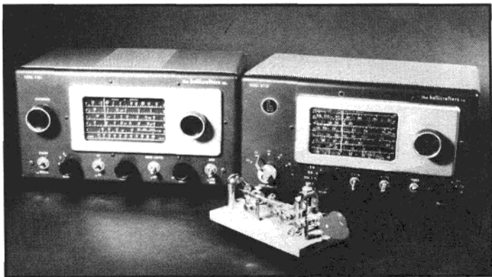
图 11-1 我的两部老式 QRP 设备：Hallicrafters S-53 超外差式接收机和 HT-18VFO 发射机。它们真是一对可爱的小家伙！接收机的频谱很宽，需要使用某种音频滤波器。发射机能够在 CW/FM 模式下（抱歉，没有 AM/SSB 模式）向空中发射清晰的信号。尽管它们已经高寿，尽管它们与今天的电台相比显得非常简陋，但它们能够让我每天在频率上度过几个小时的快乐时光。使用这样的老式 QRP 电台，不仅能够让你体验到 50 多年前的短波通信操作，而且可以让你继承业余无线电遗产中极有价值的一部分。（摄影：K7SZ）
