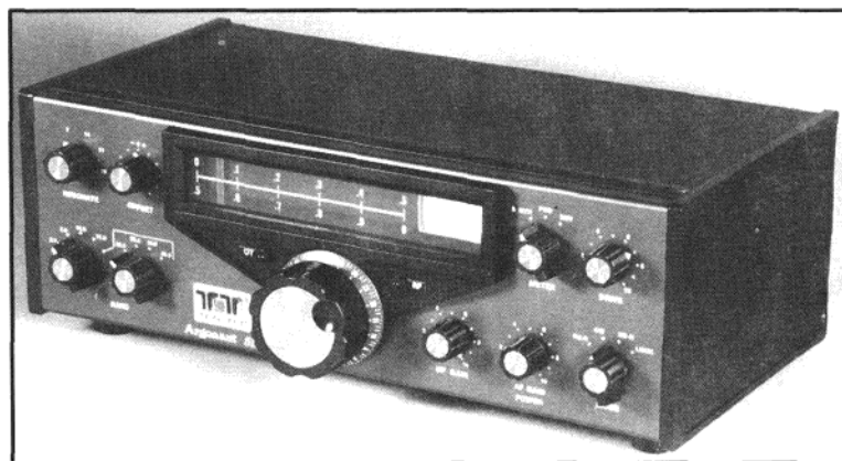
图 4-16 Ten-Tec Argonaut 515 是最后一个模拟电路 Argonaut 系列。请注意 515 和 509 的风格差别。Ten-Tec 做得正确的一件事是将 10m 波段分为 4 个 500kHz 分段。改善的接收机性能和漂亮的外观使之成为 Ten-Tec 收藏者梦寐以求的机型。一共只生产了 800 多台，因而价格特别昂贵。（摄影：K7SZ）
