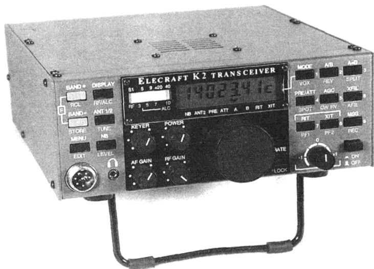
图 4-1 Elecraft K2 CW/SSB收发信机是由韦恩·伯迪克(N6KR)设计的一个完整的套件。这个单片机控制的电台有10个频道存储,支持直接键盘频率输入并有数字显示。带双VFO的异频操作以及其他许多功能让这个套件成为一个非常有吸引力的作品。(摄影:Elecraft)
