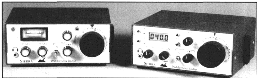
图 4-11 Wilderness Radio 出品的 Sierra 是性能卓越的极为流行的电台。多波段（160m、80m、40m、30m、20m、17m、15m、12m 和 10m）是通过使用波段模块实现的。左边是模拟表版本的 Sierra，右边是数字显示版本。Sierra 被弗兰·斯拉温斯基（KA3WTF）和保罗·斯特劳德（AA4XX）用来在 40m 波段上创造了英里 / 瓦的世界纪录。
