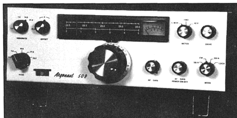
图 4-15 Ten-Tec Argonaut 509 是有史以来生产的最流行的 QRP 电台之一。尽管它们的性能不算亮眼，但是它们在二手市场绝对控制着高价。这个电台有传奇色彩的 Ten-Tec 全插入键控，在 80m、40m、20m、15m 和 10m 波段上有大约 2.5W 输出，同时有一个中庸的接收机。二手货价格高。（摄影：K7SZ）
