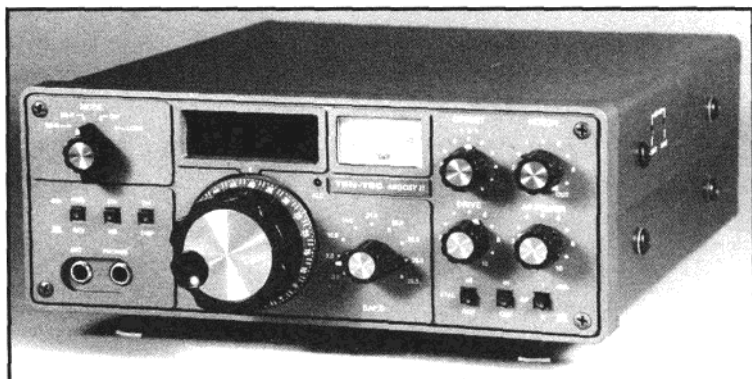
图 4-17 Ten-Tec 型号 525D Argosy-II (数字型号) 是我最喜欢的 QRP 机器之一。这是个 SSB 和 CW 模式的六波段电台 (80m、40m、30m、20m、15m 和 10m)，轻按开关可以将 QRP 功率电平升高到 50W 输出。这个电台在 QRP 和 QRO 世界中得到了最大的好处。键控是全插入的，整体性能非常好。(摄影：K7SZ)
