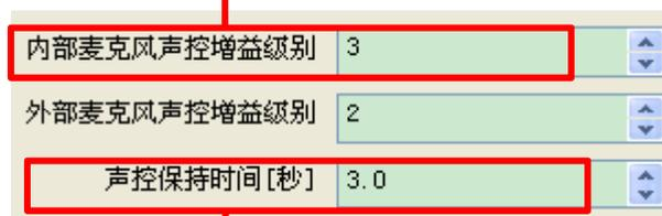
声控发射过程中，主机如果没有检测到语音时，将在声控保持时间内保持发射状态，从而保证说话停顿时主机不会停止发射。
