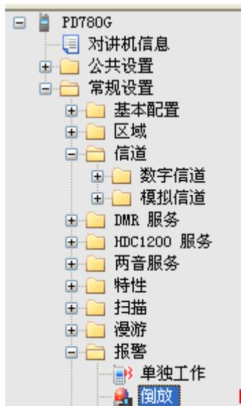
对讲机内部设置了倒放功能，如果该功能被激活，对讲机平放或倒放，在进入延时无扶正，会自动进入紧急报警模式。
