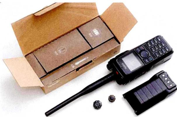
同型号机型。专业套装中所提供的大容量电池，可以保障更长时间的同频数字中继运作时间（官方数据约增加 1.5 倍的续航时间）。而更高性能的天线，可以让中继转发的信号传得更远，覆盖得更广，因为天线是射频电与磁信号形态的转换器，转换效率越高受通信中继保障的活动范围就变得越大。
