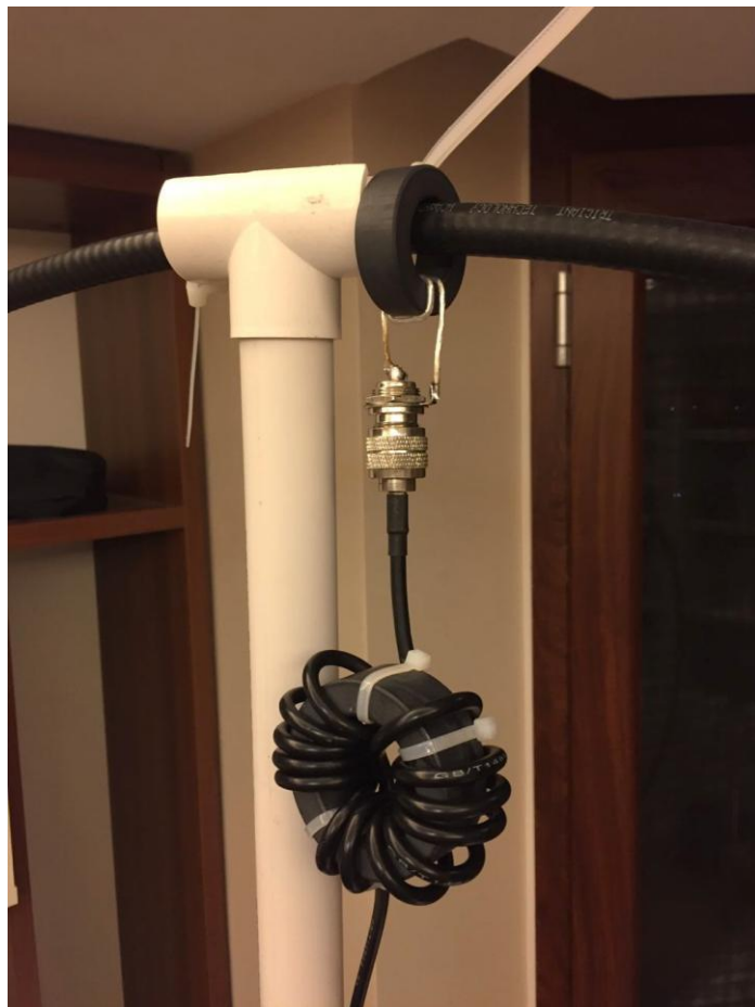
图 6 巴伦与磁环变压器的连接
