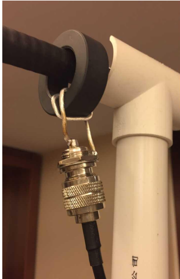
图 4 磁环变压器装配图
