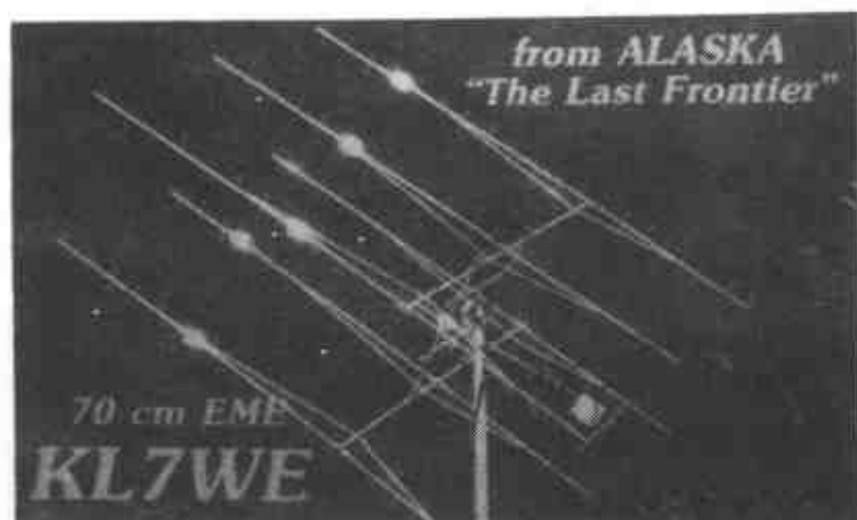
照片 10—4 由 6 根八木天线构成的 KL7WE の EME 天线(QSL)
