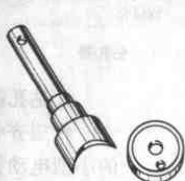
图 6—4—4 机壳冲孔器(可按确定径的大小打光洁孔)
