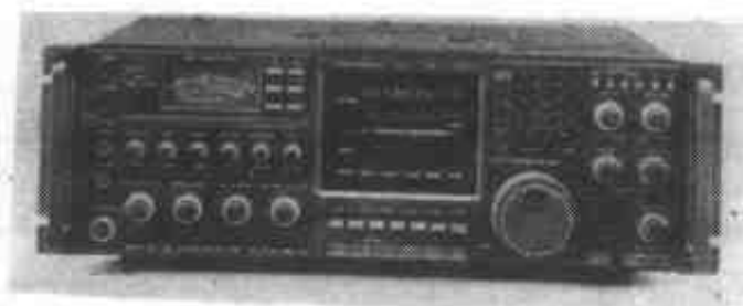
照片 7—17 内装频谱显示器的 HF 无线电收发两用机 (1C—780)
