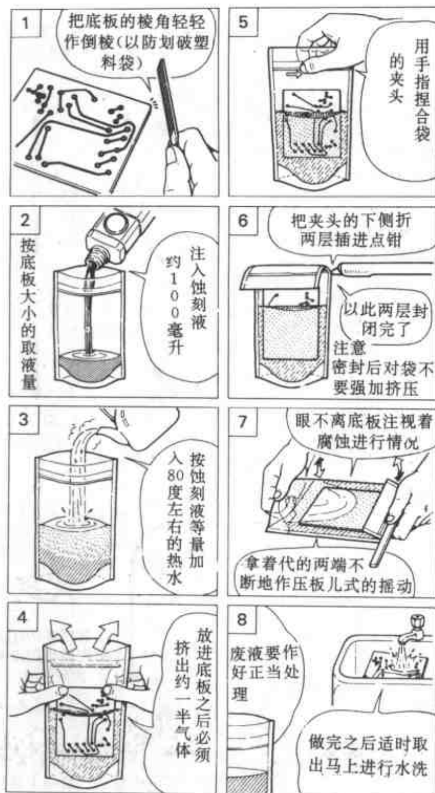
图 6-4-13 市销有非常便当的 乙烯组件型蚀刻容器
