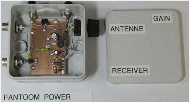
在先前的示意图中,330 欧姆电阻器为240 欧姆。有时 IC 使用短同轴电缆自激,因此电阻增加,IC 的电源电压降至5.5 伏。
