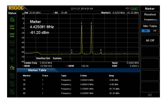
标记 1D = 2 音频发生器 3.58 MHz 标记 2D = 2 音调发生器 4 MHz 标记 3D = intermod 信号 3 <sup>的</sup>顺序= -55dBm 标记 4D = intermod 信号 3 <sup>的</sup>顺序= - 55 dBm 放大器输入端的发生器电平为-36 dBm (S9 + 35 dBm) 。 很明显,只有非常强的信号才能使放大器过载。
