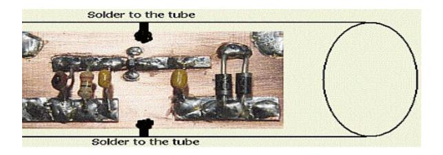
将 PCB 的两侧焊接到管的内侧("无花果")。 首先将粗线焊接到管上,然后将 PCB 焊接到电线上。
