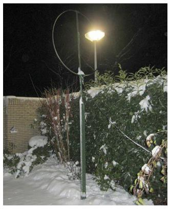
所提出的屏蔽宽带(~200 MHz)有源环形天线提供更安静且相对较少的干扰接收。众所周知,用于发射的天线也可以很好地用作接收机天线,只能忘记所有干扰信号都是成比例的。因此 PA3GZK 认为你实际上必须使用两个天线,一个用于发射,一个用于接收。后者在较低频段最需要。
