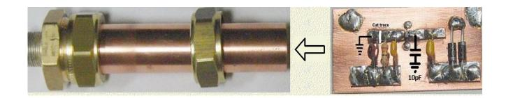
将放大器滑入 22 毫米铜管中。使用合适的烙铁在管内部焊接 PCB 的质量。也可以在柔性线的一侧使用该点。将导线的另一侧焊接到放大器的输入端。
