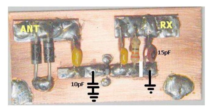
该 INA02186 具有较高的增益,良好的接地连接是必不可少的。一些 DIY 业余爱好者不得不处理引起的自激。为了防止不稳定确保输入输出信号有一个直接的通道,不要分开加工焊接,沿着信号通道在一块板子上按顺序直通焊接。
