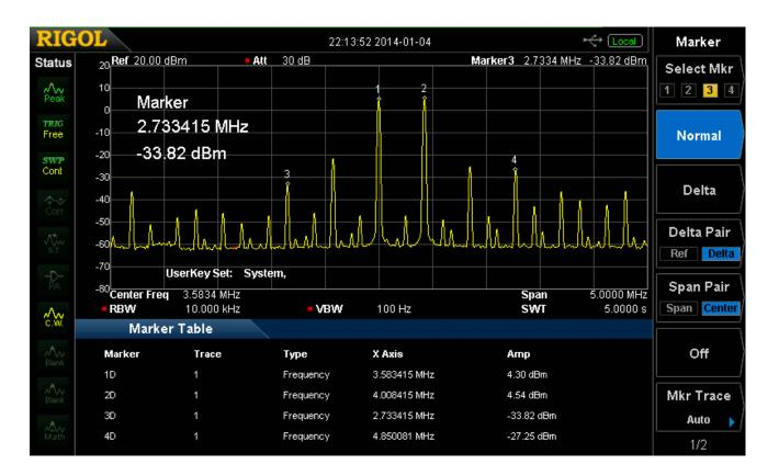
标记 1D = 2 音频发生器 3.58 MHz 标记 2D = 2 音调发生器 4 MHz 标记 3D = intermod 信号 3 <sup>的</sup>顺序= -33dBm 标记 4D = intermod 信号 3 <sup>的</sup>顺序= -27dBm 放大器输入端的发生器电平为-26 dBm (S9 + 50 dBm) 。天线不太可能接收到如此强的信号。
