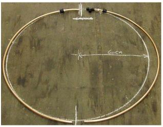
15 毫米直径的软铜管(来自五金店)长 4 米,实际上有两个易弯曲的 2 米长的碎片。"弯曲轨道"标有 蜡笔和一根绳子。 (用一根绳子为圆的半径用蜡笔或粉笔画出尺寸图纸)
