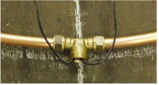
柔性绝缘线不需要在铜管中心布置,只要穿过铜管就可以。
