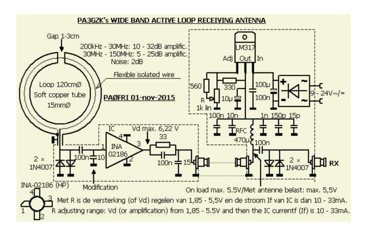
PA3GZK 以各种形式构建了许多有源天线,并进行了广泛的实验。这里描述的天线 (上图)给出了迄今为止最好的性能,它是各种电路和系统的许多测试的最终结果。对于功能正常的天线以及系统的基本对称性,建议尽可能遵循机械结构。
