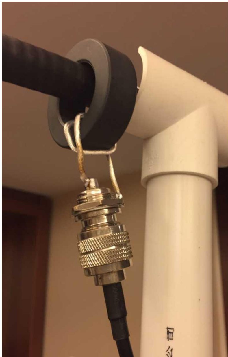
图 3 磁环变压器装配图
