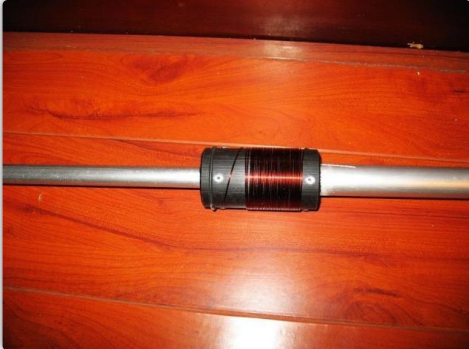
图三：1.0mm漆包线缠绕的加感线圈
