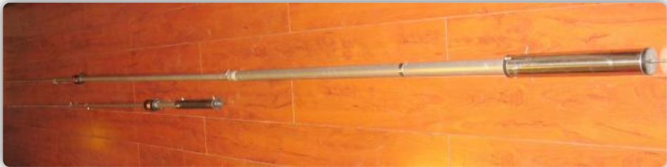
图六：采用中部加感的GP天线实物图
