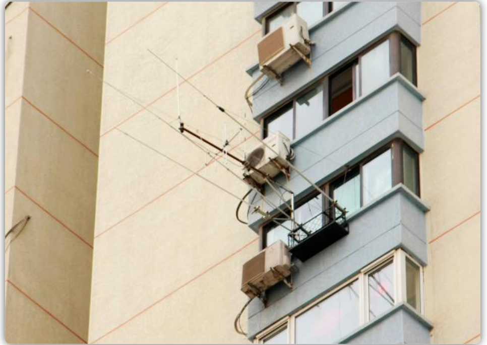
图十：我的3根单波段GP天线（15米、20米、40米波段）
