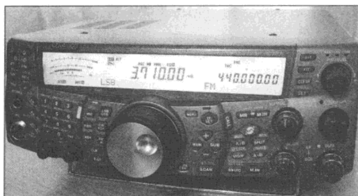
图 4.41 Kenwood 公司的 TS-2000 不仅覆盖整个短波频段，而且还具有 VHF 和 UHF 全双工卫星通信能力
