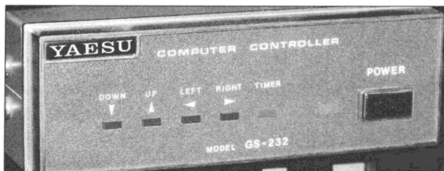
图 4.29 八重洲 GS-232 允许你的计算机和卫星跟踪软件自动控制方位角 / 仰角天线旋转器
