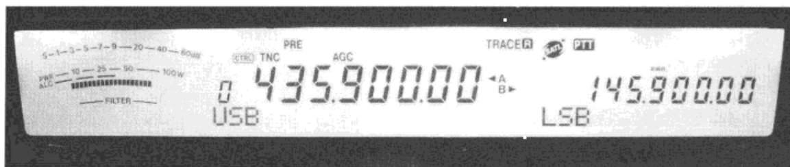
图 5.10 一个收发信机的范例（Kenwood TS-2000），在倒频模式下使用双 VFO 工作模式。 在用于接收的主 VFO 调整好以后，副 VFO（在右边）会同步跟踪
