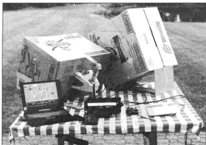
图 6.74 整套卫星地面站包括跟踪用的便携电脑, FT-847 以及上下行链路两个天线。(嘿,认得出来桌上那个电键吗?那是 1944 年出品的 J-38,跨越了 60 年的时代!——编者)
