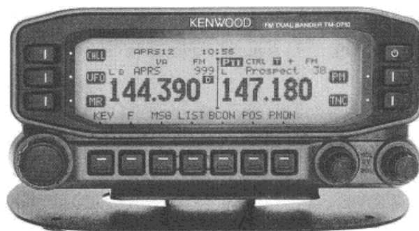
图 4.38 Kenwood 的 TM-D710 是一个具有用于数字通信的内置无线分组通信终端节点控制器(TNC)的双波段收发信机
