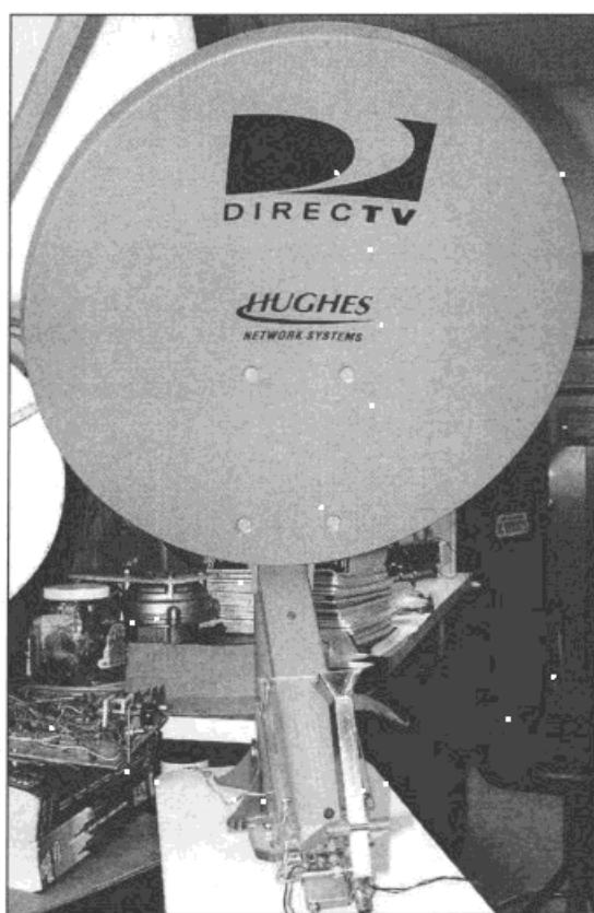
图 4.22 这是偏置式馈电碟的很好的例子。注意，馈源在照片底部的边缘，指向抛物面的中心。 另请注意，这是一个美国直播电视公司的卫星电视天线，已被“改变用途”，用于业余卫星
