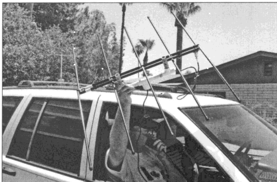
图 4.48 WD9EWK 停下车，在车上利用 OSCAR 51 卫星上的调频中继进行通联。他使用一副短主梁的 2m 八木天线用于上行链路，在他的车后身，一副全向天线用于 70cm 的下行链路
