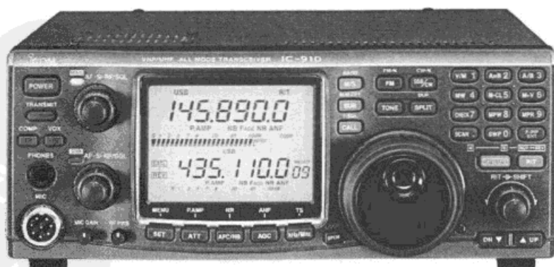
图 4.40 ICOM 公司生产的 IC-910H 是用于 VHF/UHF 卫星通信的收发信机
