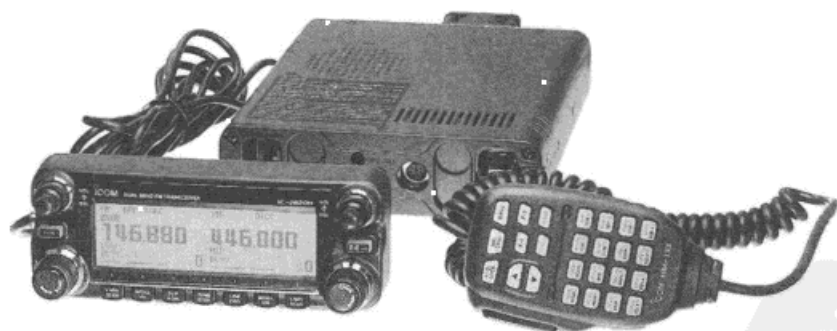
图 4.37 ICOM 公司生产的 IC-2820 调频收发信机能在 2m 和 70cm 波段独立接收和发射。 有了这样的双波段调频设备，你可以通过卫星调频中继进行通联，甚至可在汽车上通联
