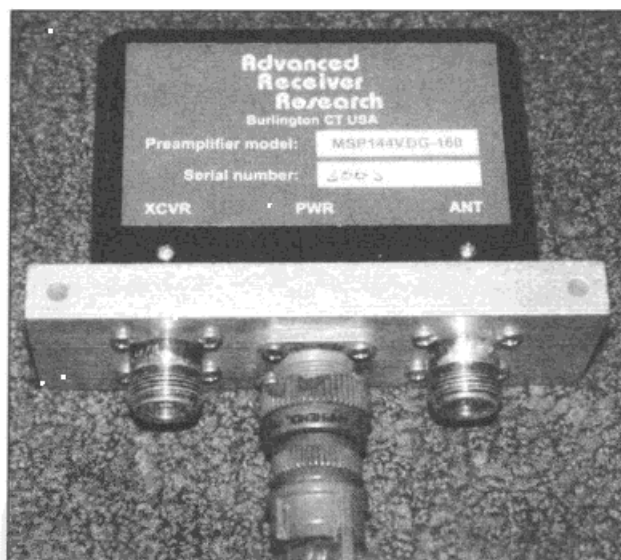
图 4.30 Advanced Receiver Research 研制的接收机前置放大器，在信号从同轴电缆到达你的接收前使信号大大增强
