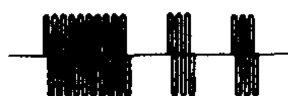
图 7-3 等幅电报信号的波形图
