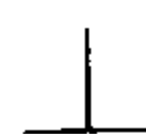
图 7-4 等幅电报信号的频谱图
