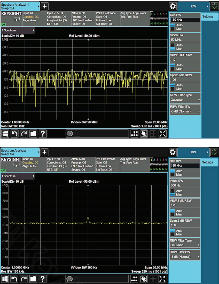
图 5-3. 视频滤波使得低电平信号更易分辨
